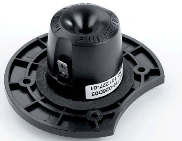
Il tweeter è realizzato con una cupola morbida da 26 millimetri e con un magnete al neodimio. Notare la camera posteriore di decompressione che riduce notevolmente le colorazioni interne.
