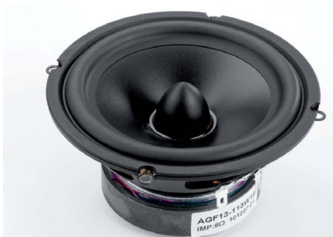
Il woofer ha il cestello di lamiera stampata. Notare la foratura al di sotto del centratore e la lucida membrana in polipropilene e mica. Il rifasatore centrale ottimizza le già buone doti di dispersione del trasduttore.
