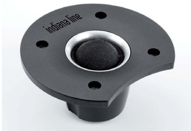
Il tweeter è realizzato con una cupola morbida da 26 millimetri e con un magnete al neodimio. Notare la camera posteriore di decompressione che riduce notevolmente le colorazioni interne.
